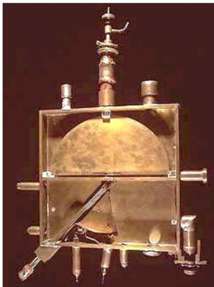
Рис. 6.2. Первая работающая модель циклотрона
