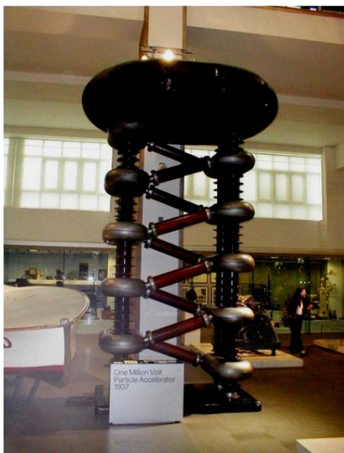
Рис. 6.1. Один из умножителей напряжения, построенный в 1937 г. компанией Philips для использования в ускорителе на энергию в 1 МэВ. В настоящее время находится в Национальном музее науки в Лондоне. Такие ускорители в 40-е гг. прошлого столетия применялись при разработке атомной бомбы
